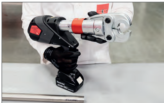
Preparazione della macchina pressatrice / Press machine preparation
