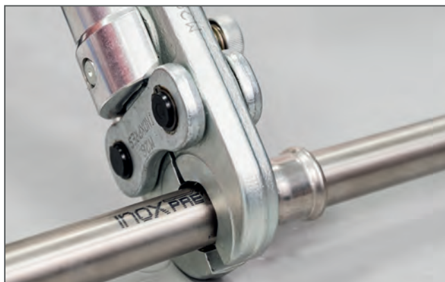
Assemblaggio attraverso pressatura / Making the press connection
