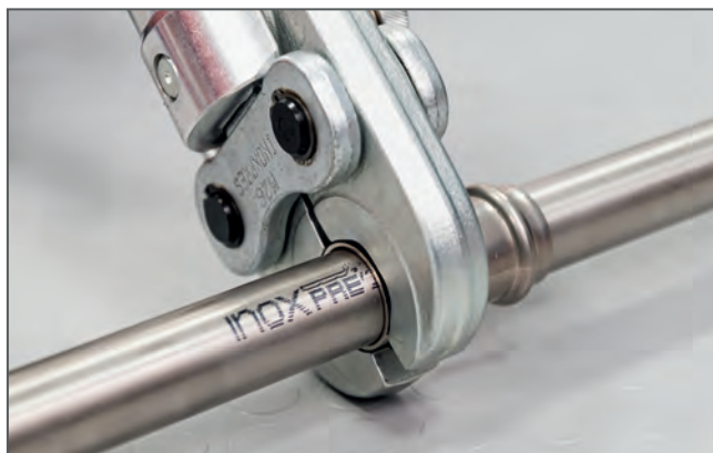
Assemblaggio attraverso pressatura / Making the press connection
