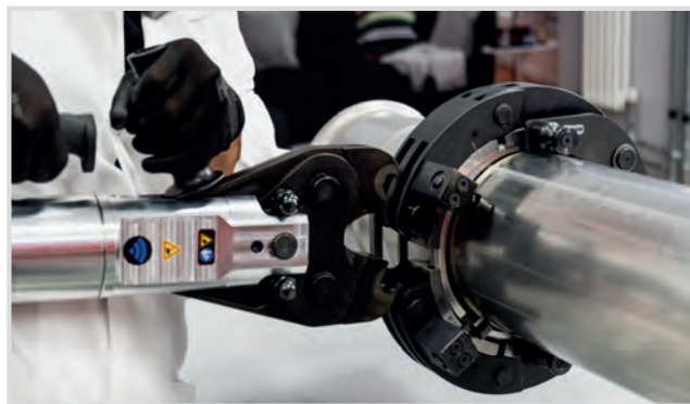
Assemblaggio pressatura n°1 / Press assembly phase 1
