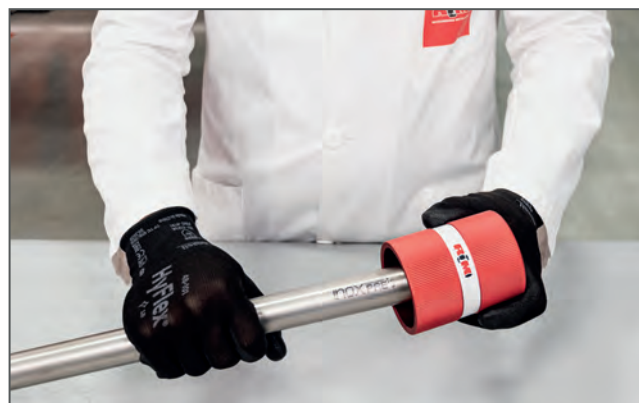
Sbavatura del tubo / Deburring the pipe
