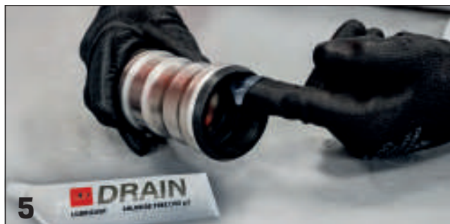
Lubrificazione zona interna guarnizione / Internal gasket lubrication
