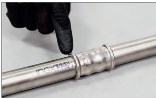
Controllo della pressatura / Checking the press connection
