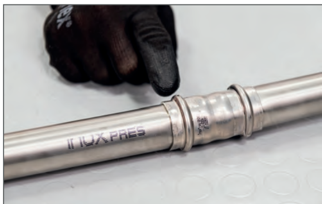
Controllo della pressatura / Checking the press connection
